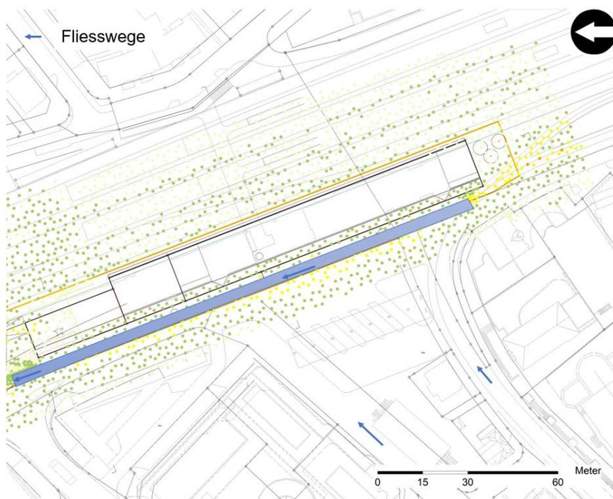
Abbildung 10 Darstellung Abflusskorridor zum Ableiten des Hochwassers- und Oberflächenabflusses.
