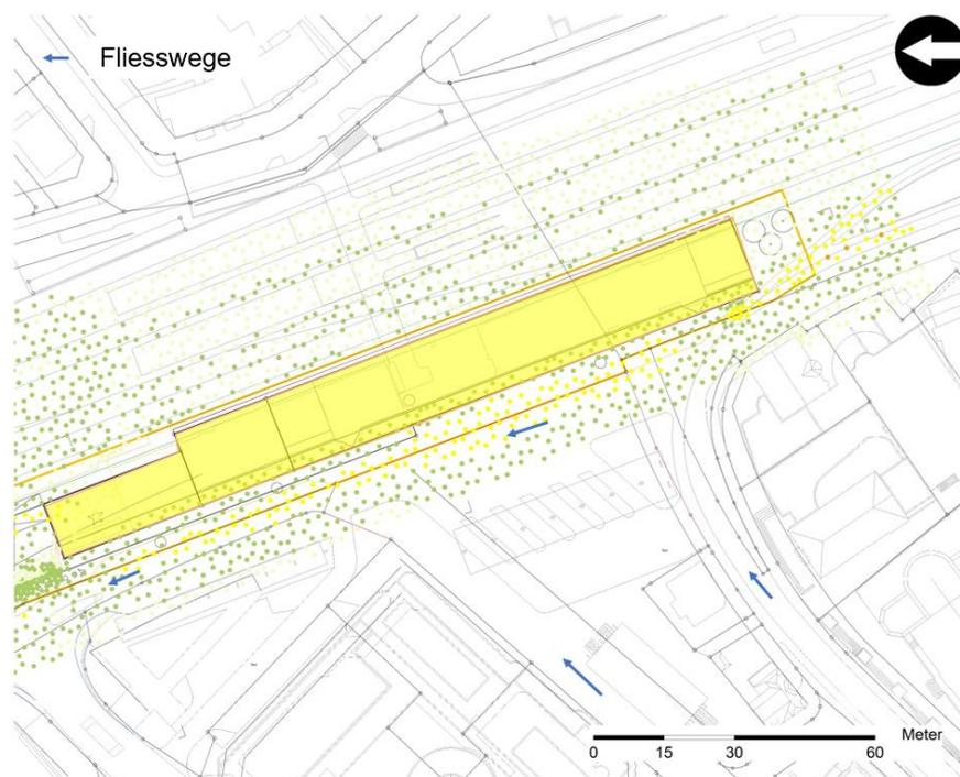
Abbildung 9 Anhebung der Gebäude über Schutzkote (in Gelb Baubereich A).
