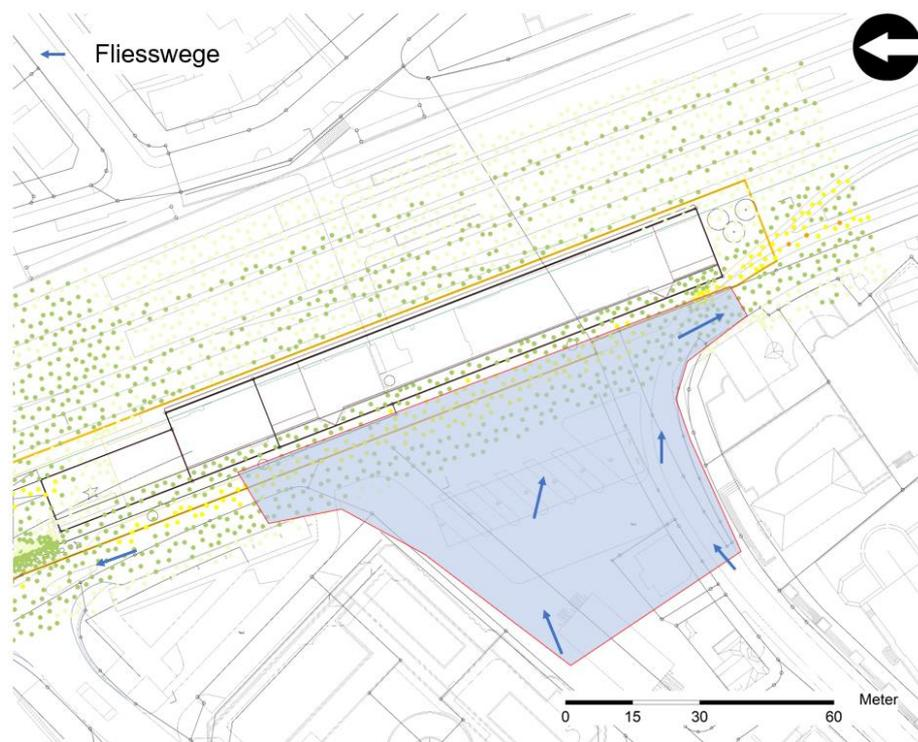
Abbildung 11 Anpassung Bahnhofplatz für das Umleiten von Hochwasser und Oberflächenabfluss
