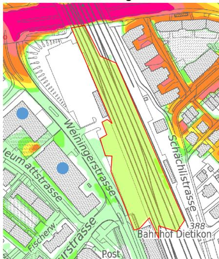
Abbildung 18 Fläche, die aufgrund des verstellten Fliesswegs bei einem HQ300 nicht mehr überflutet werden kann. Mit blauen Punkten sind die betroffenen Objekte markiert.
