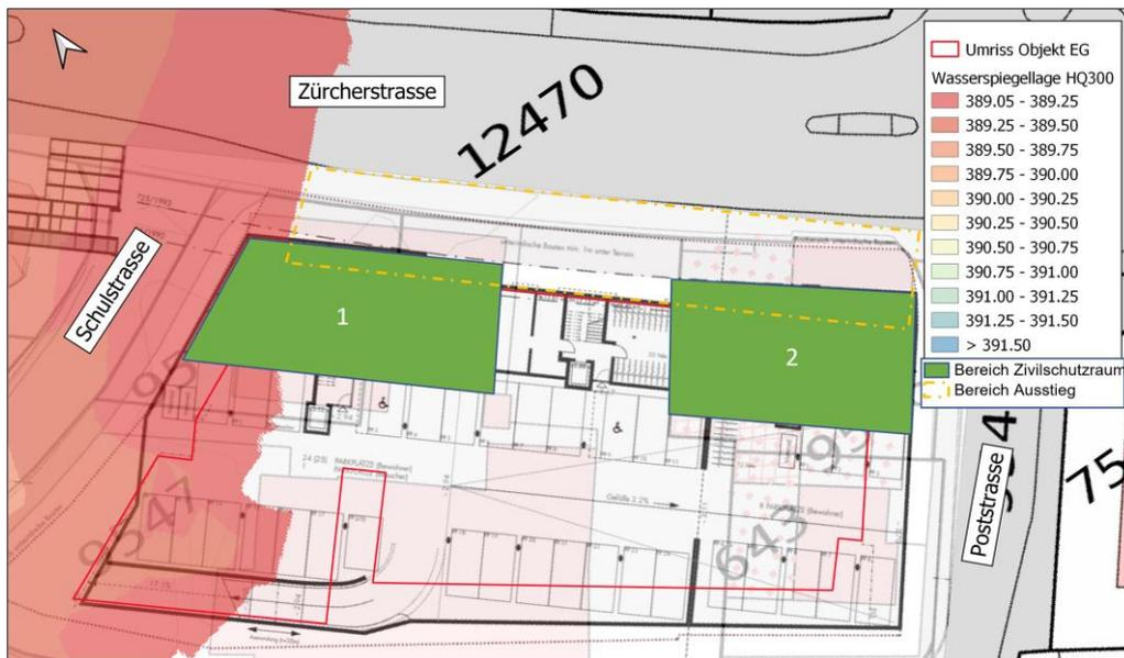
Abbildung 11: mögliche Lage der Ausstiege der potenziellen Zivilschutzräume mit der Wasserspiegellage HQ300.
