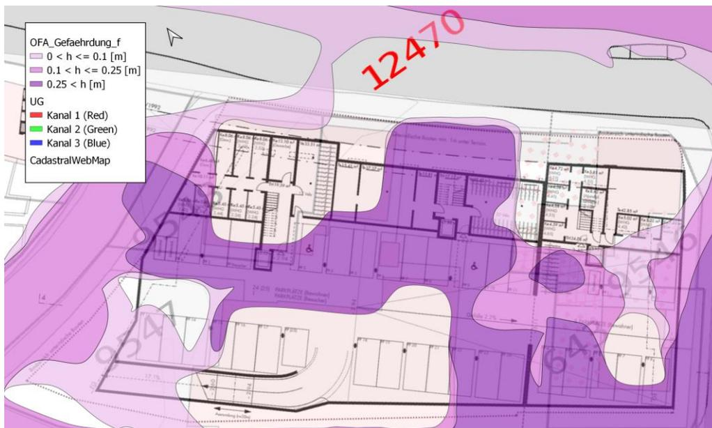
Abbildung 4: Ausschnitt Gefährdungskarte Oberflächenabfluss [3]
