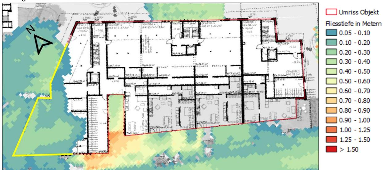
Abbildung 9: projektiertes Objekt in der Draufsicht unter Einfluss eines HQ300 mit gelb markiertem Bereich, an welchem der Schutz gegeben sein muss. Neben dem Objekt wird das gewachsene Terrain dargestellt, Senken werden im Rahmen des Projekts ausgeebnet.
