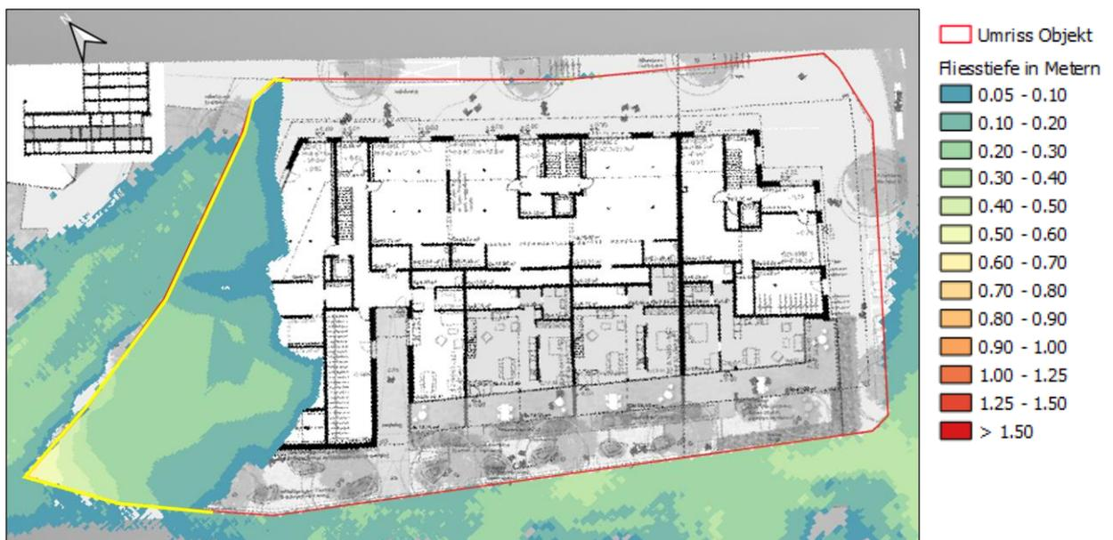
Abbildung 12: Parzellengrenze in der Draufsicht unter Einfluss eines HQ300 mit gelb markiertem Bereich, an welchem der Schutz gegeben sein muss. Neben dem Objekt wird das gewachsene Terrain dargestellt, Senken werden im Rahmen des Projekts ausgeebnet.
