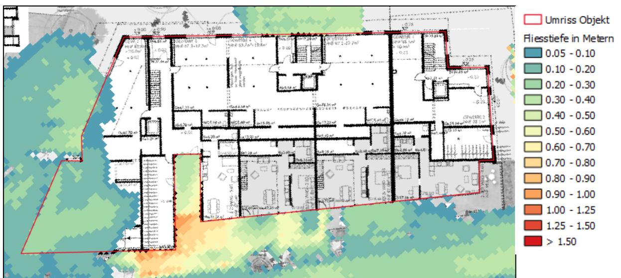
Abbildung 5: Fliesstiefenkarte HQ300 für das Objekt mit vorgesehener Kote Erdgeschoss von 389.05 m ü. M. Neben dem Objekt wird das gewachsene Terrain dargestellt, Senken werden im Rahmen des Projekts ausgeebnet.
