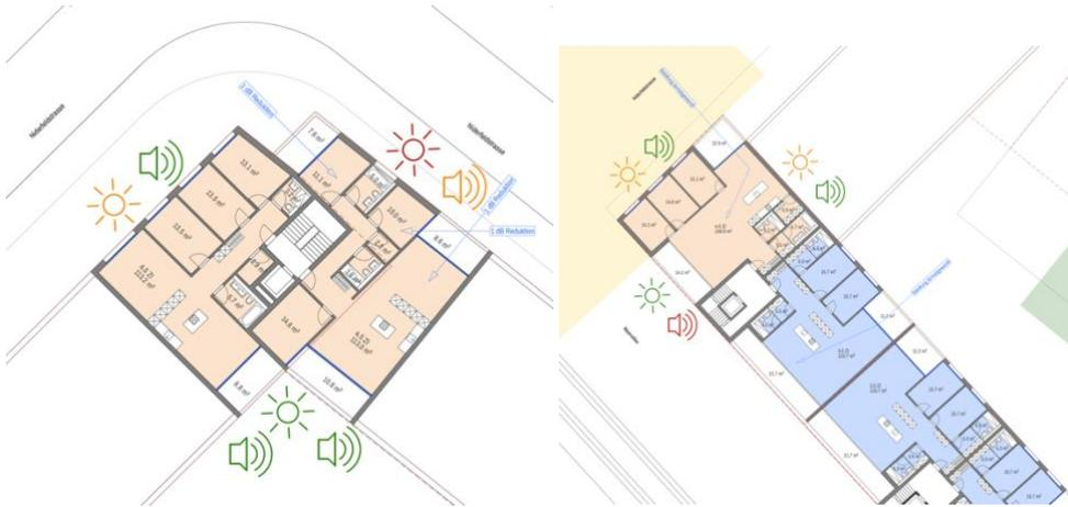
**Lärmgrundrisse Baufeld J1,1-1.2 (links) und Baufeld G1.1 (rechts) (DN Architekten 08/2023)**
