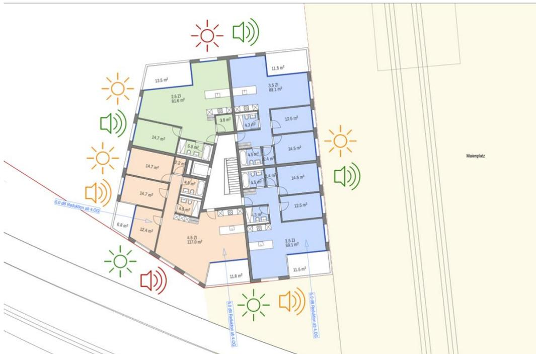
**Lärmgrundriss Baufeld B1(DN Architekten 08/2023)**
