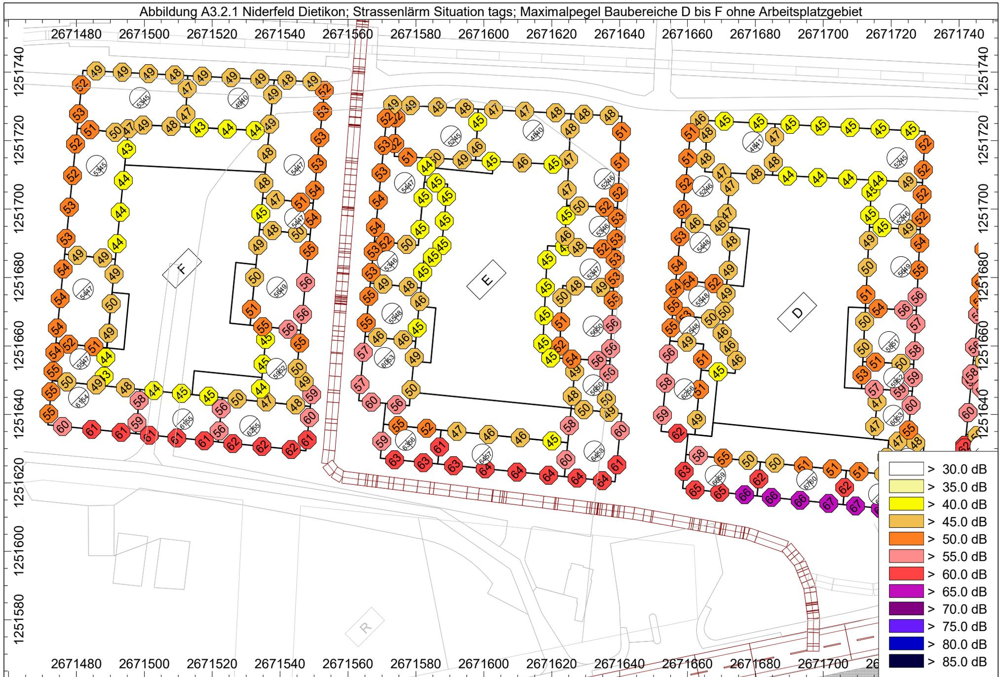
Abbildung A3.2.2 Niederfeld Dietikon; Strassenlärm Situation nachts; Maximalpegel Baubereiche D bis F ohne Arbeitsplatzgebiet
