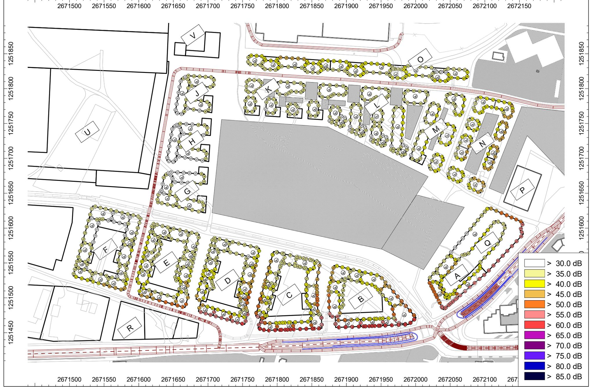
Abbildung A3.1.3 Niderfeld Dietikon; Strassenlärm Situation tags; 3-D Ansicht Baubereich A und Q bei Vollausbau
