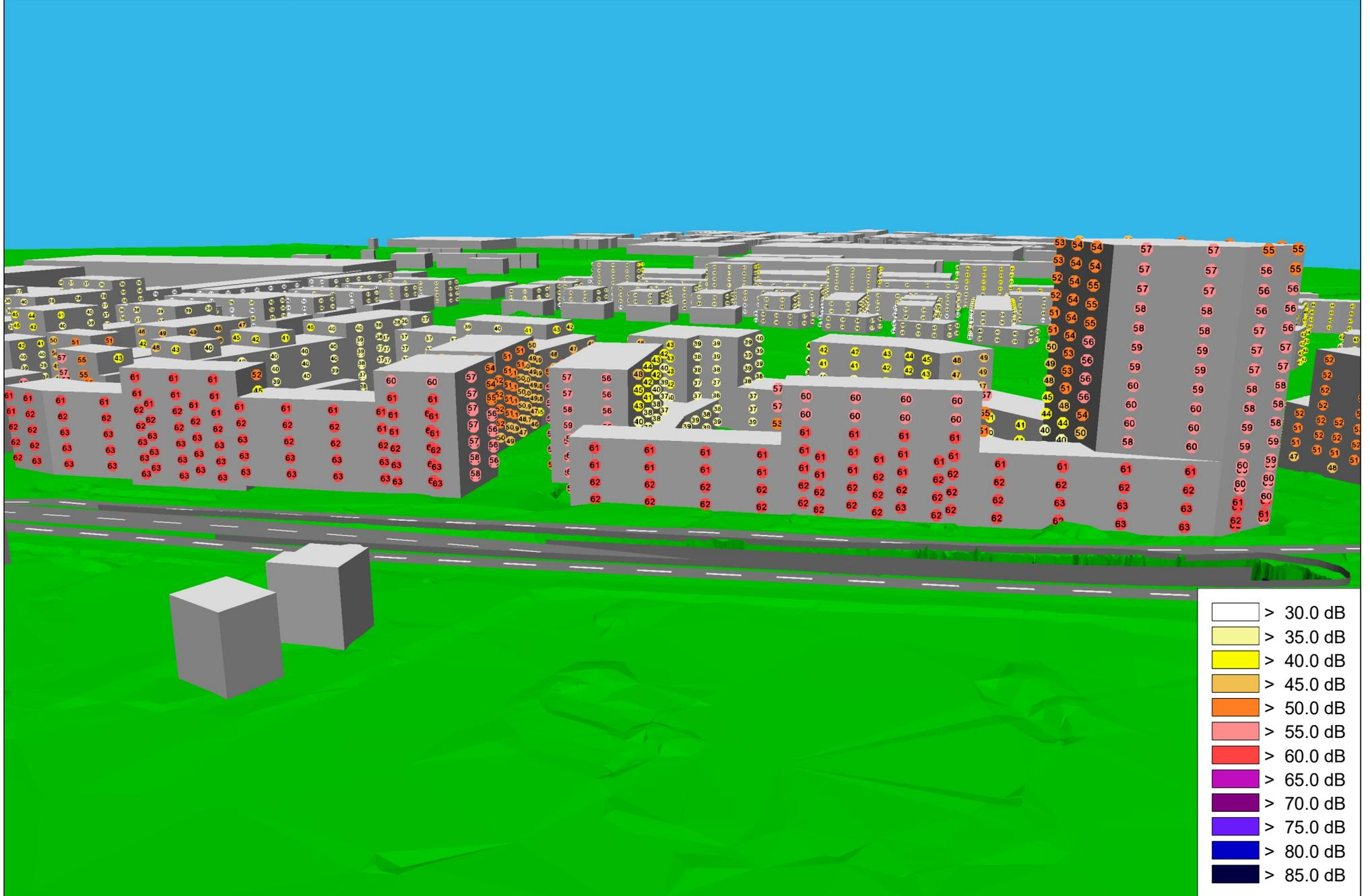
Abbildung A3.1.7 Niderfeld Dietikon; Strassenlärm Situation tags; 3-D Ansicht Baubereich D bei Vollausbau
