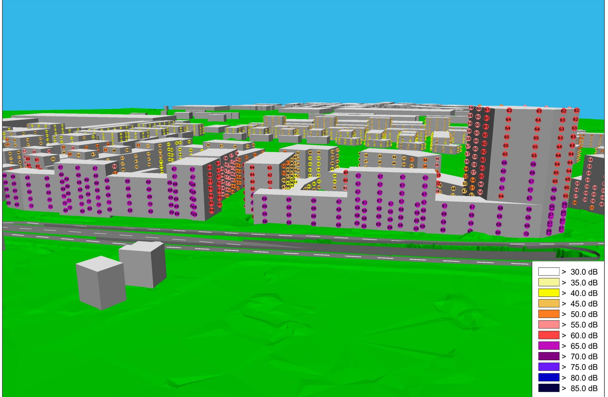
Abbildung A3.1.6 Niderfeld Dietikon; Strassenlärm Situation nachts; 3-D Ansicht Baubereiche B und C bei Vollausbau
