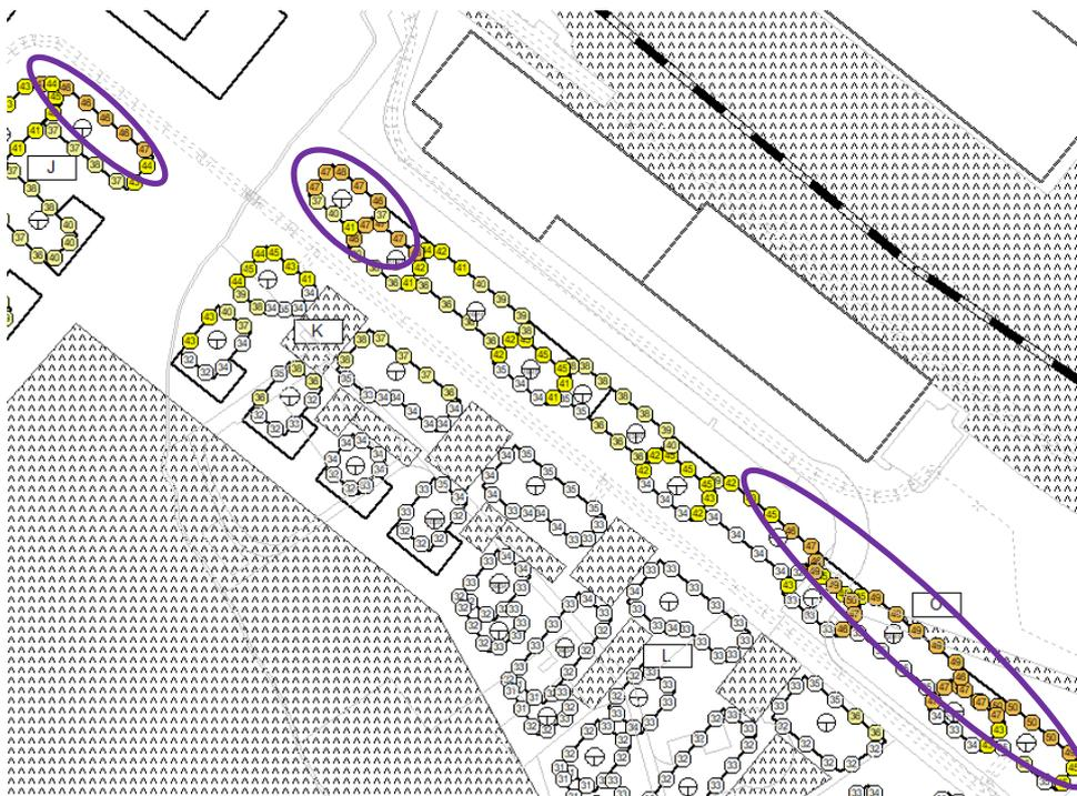
Abbildung 7: Bereiche mit PW-Überschreitung (violett) im Einflussbereich der Eisenbahnlinie
