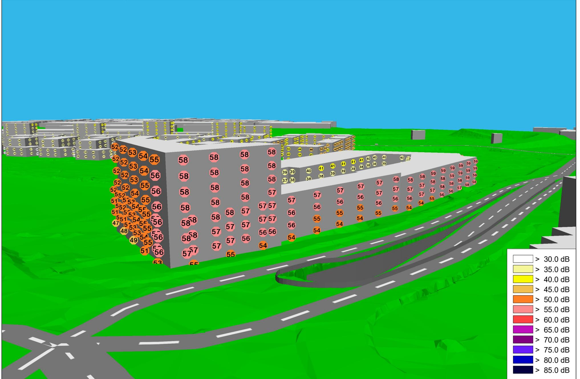
Abbildung A3.1.5 Niderfeld Dietikon; Strassenlärm Situation tags; 3-D Ansicht Baubereiche B und C bei Vollausbau
