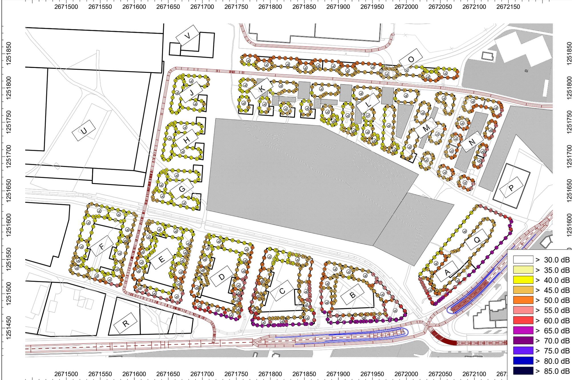
Abbildung A3.1.2 Niderfeld Dietikon; Strassenlärm Situation nachts; Maximalpegel bei Vollausbau
