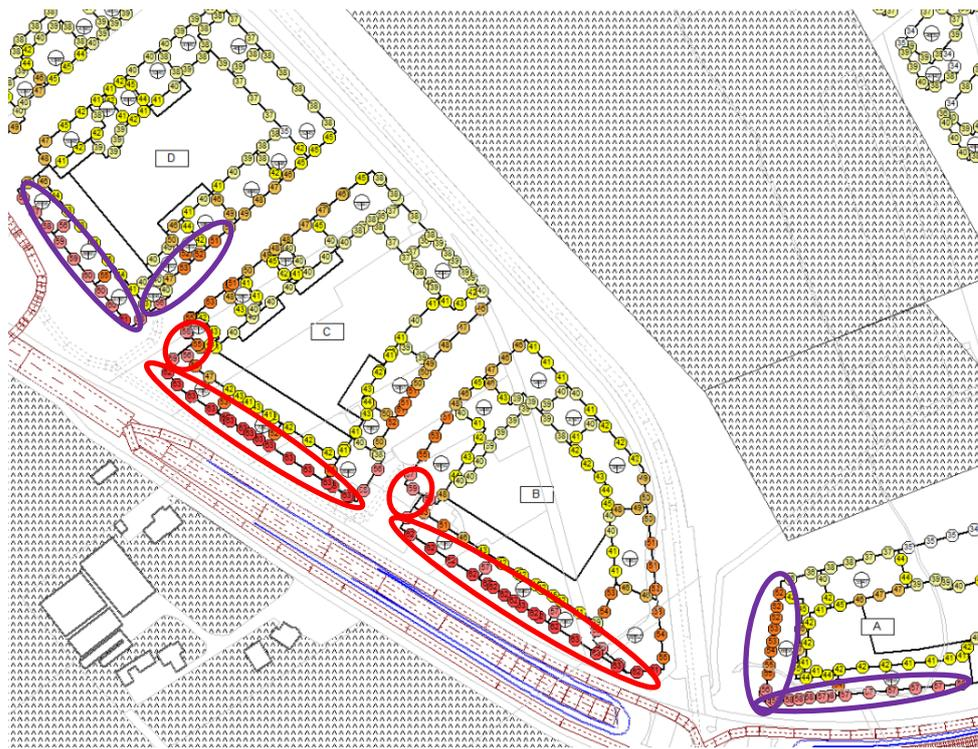
Abbildung 4: Bereiche mit IGW-Überschreitungen (rot) und PW-Überschreitungen (violett) im Einflussbereich der Überlandstrasse
