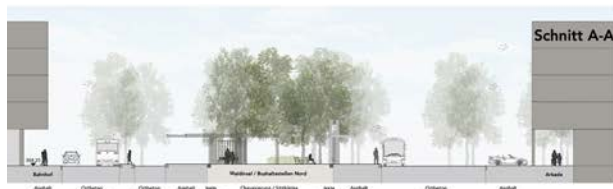
Querschnitte Businseln Nord und Süd 1:250 (verkleinerte Darstellung)
