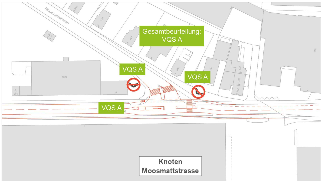
Abb. 47 Geometrie und verkehrstechnischer Nachweis (VQS) Knoten Moosmattstrasse [15]
