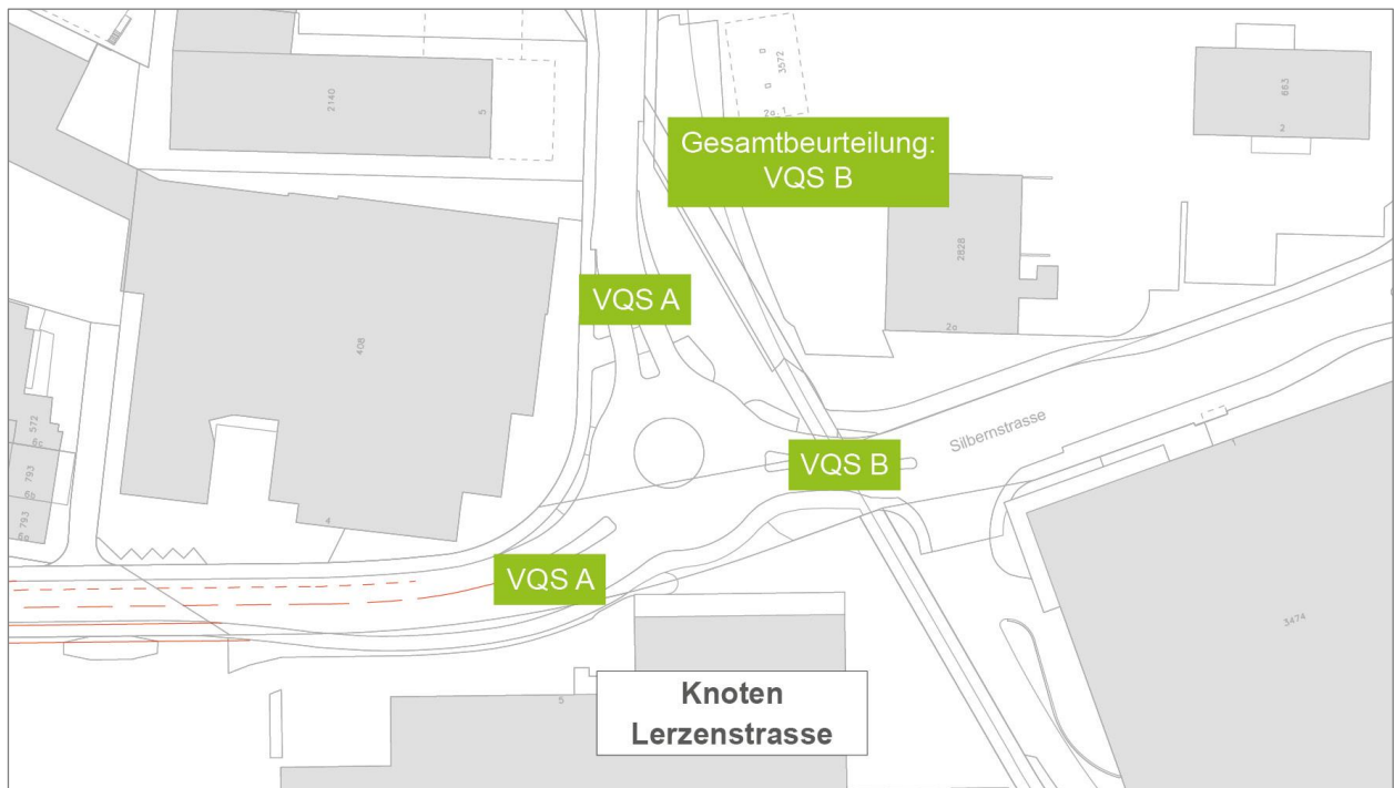
Abb. 48 Geometrie und verkehrstechnischer Nachweis (VQS) Knoten Lerzenstrasse [15]
