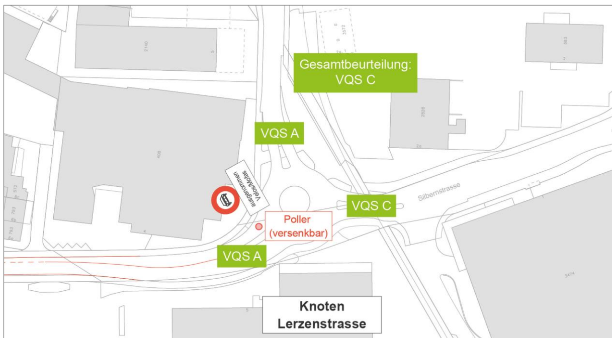
Abb. 60 Geometrie und verkehrstechnischer Nachweis (VQS) Knoten Lerzenstrasse [15]
