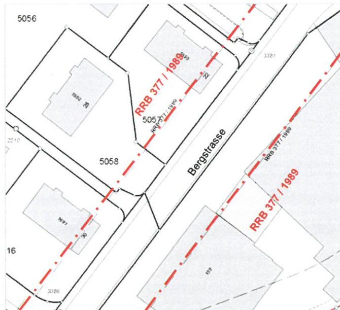
Abbildung 10: Auszug aus dem Katasterplan der Amtlichen Vermessung - Baulinie (Quelle: SWR-WebGIS)
