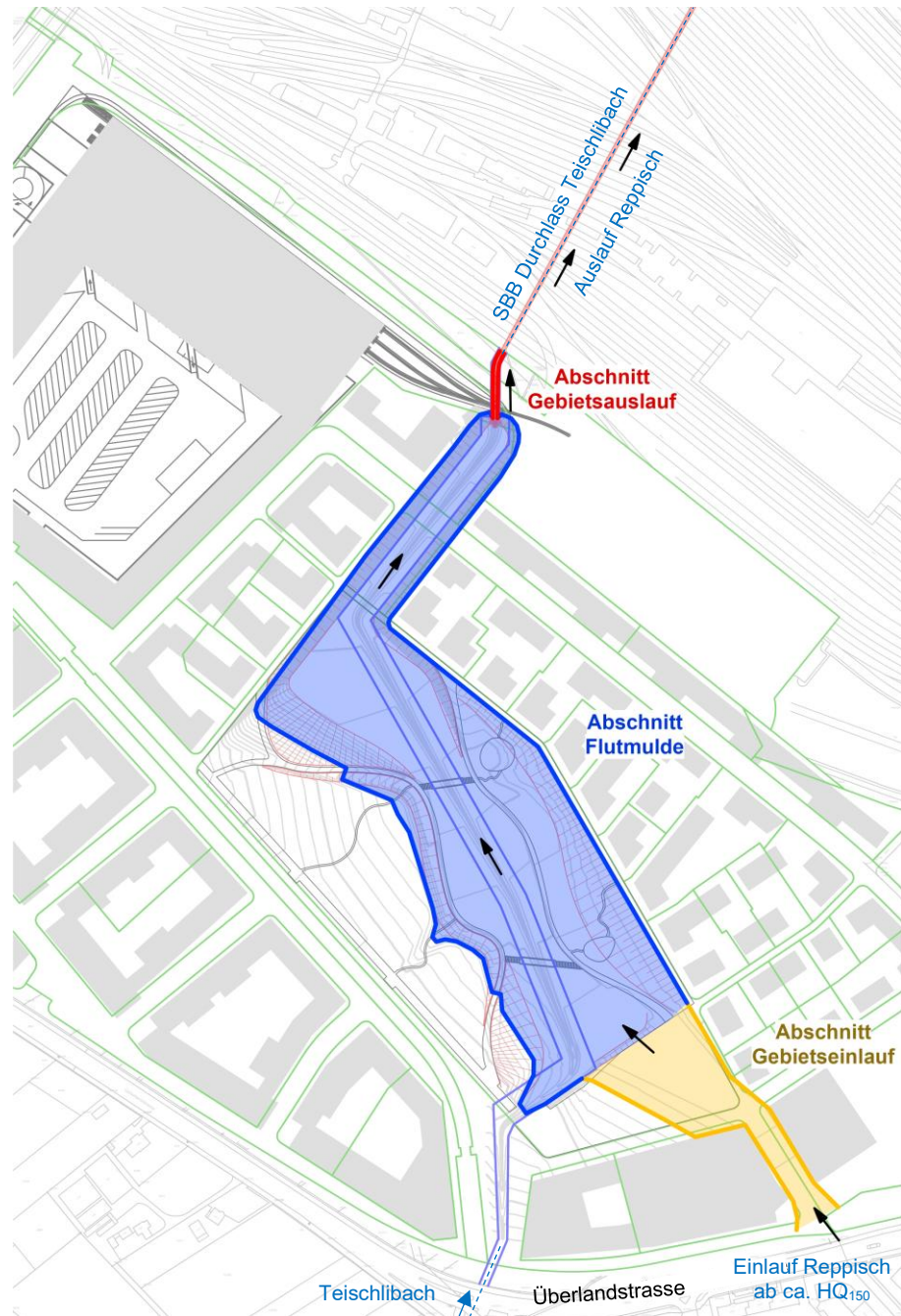
Abb. 21 Abschnitte Überlastfall Reppisch
